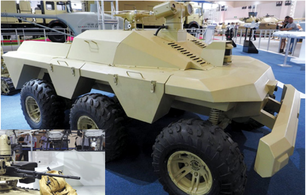
Le véhicule terrestre chinois 6x6 sans équipage Sharp Claw II est conçu pour remplir une variété de rôles, dont la reconnaissance, la surveillance, le soutien technique au combat, la logistique et le combat.
